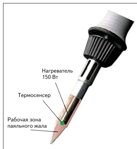
Рис. 2. Позиция нагревателя с термодатчиком в полости жала
